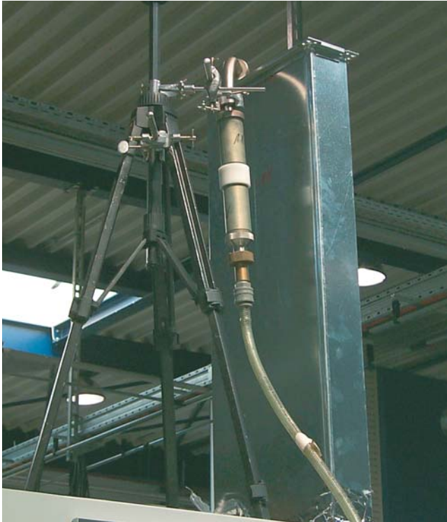
Abb. 8: IPS in der Reingluft hinter einem Abscheider
