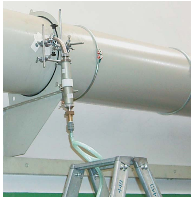
Abb. 7: Isokinetische Teilstromentnahme in der Rohluft vor dem Abscheider
