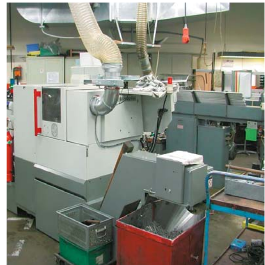
Abb. 18: Eingehauste Maschine mit Späneaustrag
